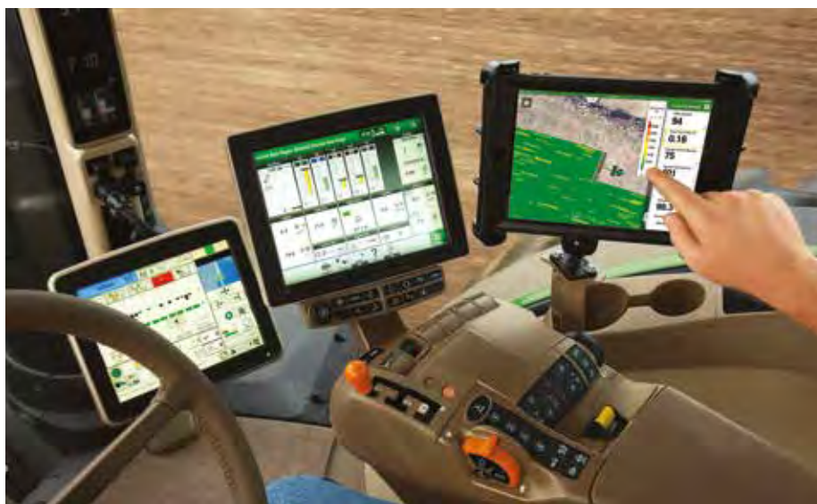
» O sistema Operations Center da John Deere permite que os agricultores recolham dados do equipamento, vejam e analisem esses dados em painéis, partilhem dados com parceiros e operem máquinas remotamente
